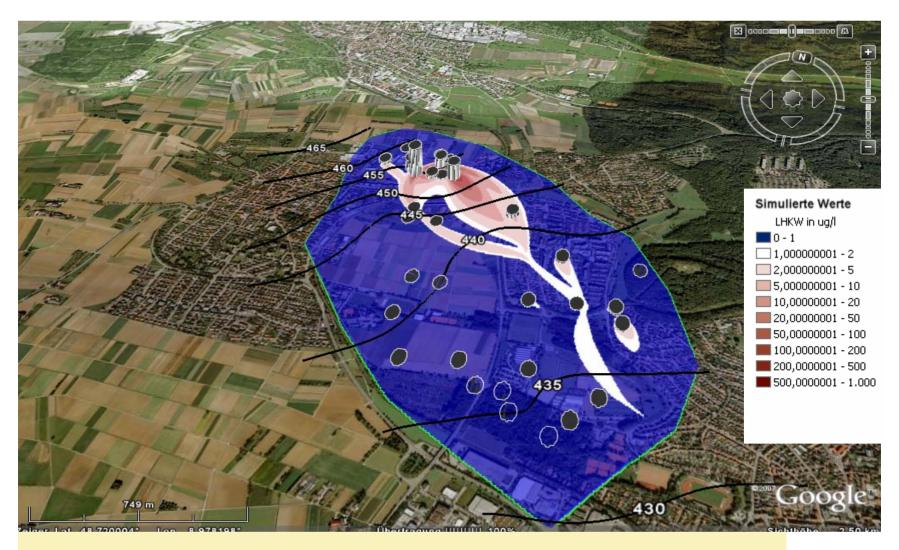
Grundwasserbeprobung 2009 Ergebnis: CKW 0,2 µg/l bis 200 µg/l
